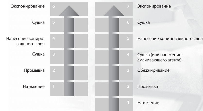
Сетка SEFAR® PET 1500 имеет новый тип обработки и не требует обезжиривания
